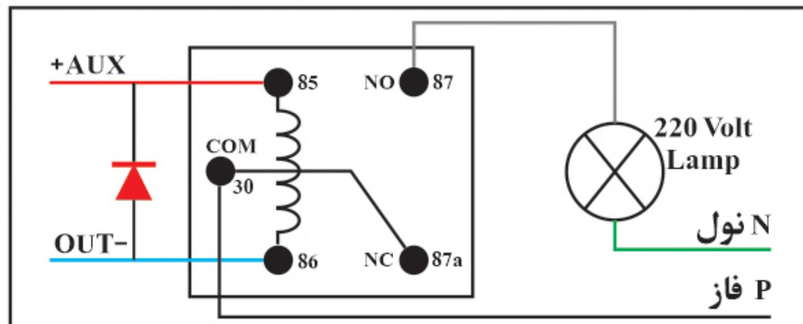
۲- خروجی منفی دائم (اعلام روشن بودن دستگاه): در این حالت هرگاه دستگاه فعال شود، ترمینال OUT- خروجی منفی دائم می‌دهد که به طور مثال می‌توان یک چراغ (سری با مقاومت ۱ کیلو) و یا یک رله را روشن کرد.
